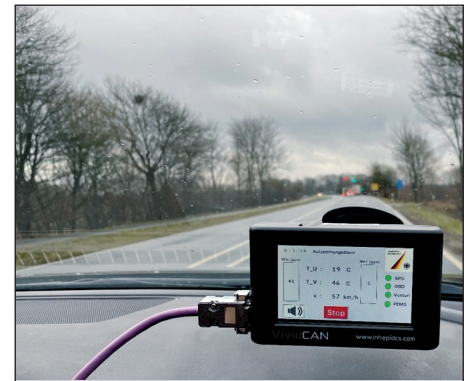
▲ Das Display des Mini-PEMS Screeningtools, montiert an der Windschutzscheibe. Bild: systec Controls
